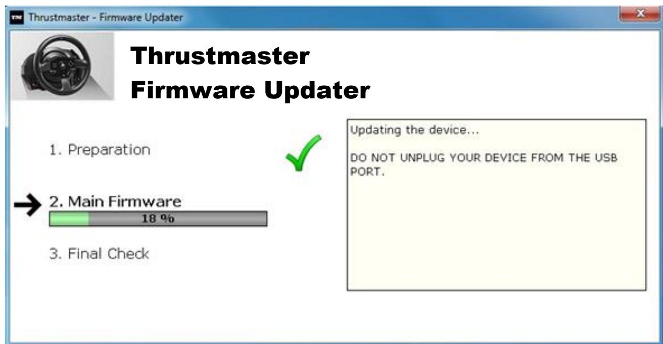
Der Aktualisierungsprozeß beginnt (der Fortschritt wird am Bildschirm angezeigt). Während der Firmwareaktualisierung geht die **MODE** LED am Lenker AUS. Dies ist völlig normal.
